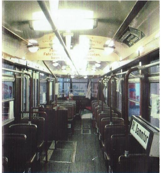
Die Beleuchtung von 3363 funktionierte einst mit 110 Volt Gleichstrom, hier musste auf die heute üblichen 220 Volt Wechselstrom umgestellt werden. Glücklicherweise konnten die Fassungen der alten Neonleuchten weiter benutzt werden denn die handelsüblichen Neonröhren aus dem Baumarkt passten haargenau. Erhalten blieben auch die alten Beschriftungen an der Decke, so erfährt man zum Beispiel, dass Schwarzfahren damals mit 20 Mark geahndet wurde!
